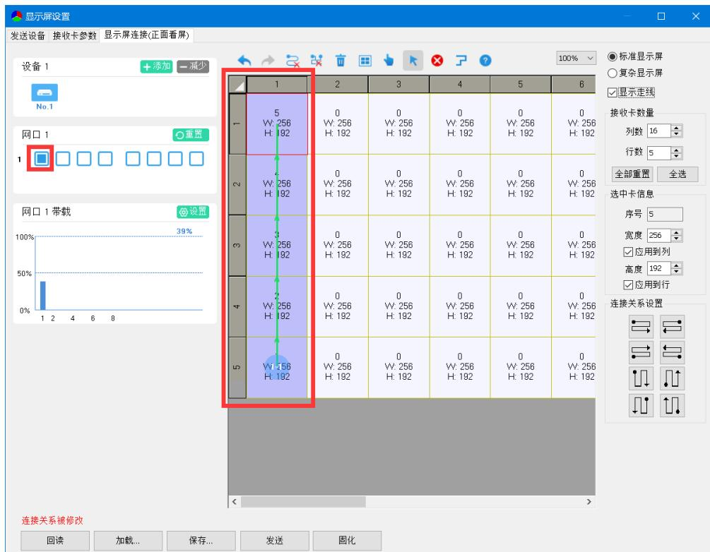
对于多种不同规格的箱体（箱体尺寸不一致的），设置完成后，可选中尺寸不同的箱体，单独进行调整即可。
