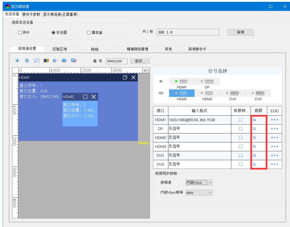
在裁剪设置界面中，勾选【裁剪】，在【裁剪信息】中设置 X（行起点）、Y（列起点）、W（宽度）、H（高度），完成裁剪。
